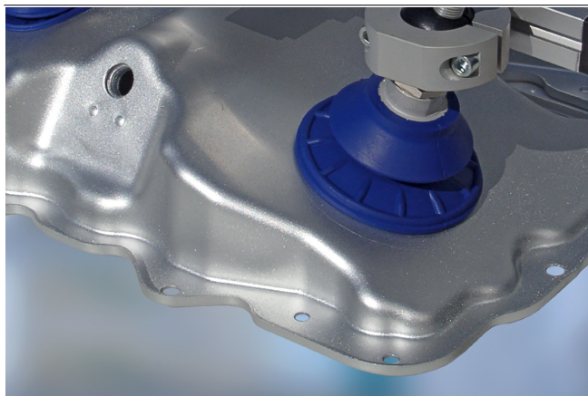
Ventose a soffiutto SAB per la movimentazione di parti di carrozzeria di automobili
